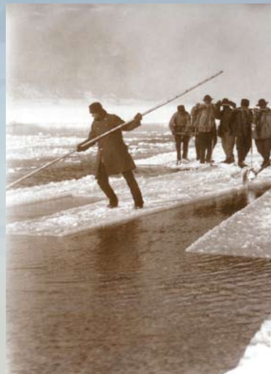
Le sciage de la glace et le guidage des blocs à l'aide de gaffes.
